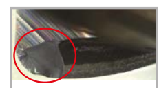
Abplatzung durch zu geringe Stabilität der Geometrie
