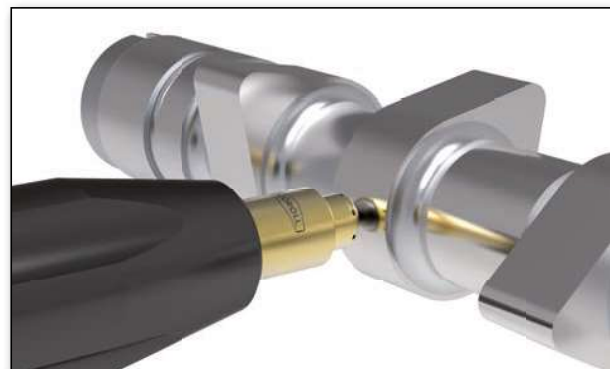
Hartglattwalzen einer Nockenwelle
