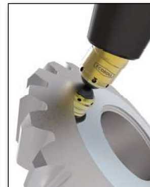
Glattwalzen der Kugelzone eines Kegelrades.
