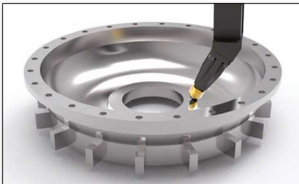
Bearbeitung eines Wandlergehäuses mit HG13, um Gleiteigenschaften zu optimieren.
